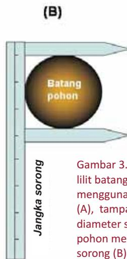
Gambar 3. Cara pengukuran lilit batang pohon menggunakan pita pengukur (A), tampak atas pengukuran diameter setinggi dada (DBH) pohon menggunakan jangka sorong (B) (Weyerhaeuser dan Tennigkeit, 2000)
