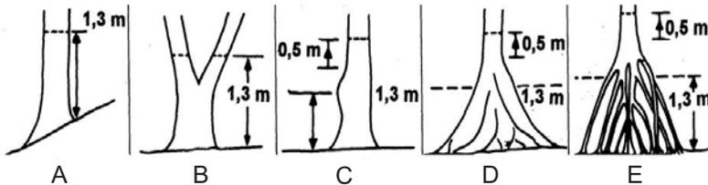
Gambar 4. Skematis cara menentukan ketinggian pengukuran DBH batang pohon yang tidak beraturan bentuknya (Weyerhaeuser dan Tennigkeit, 2000)
